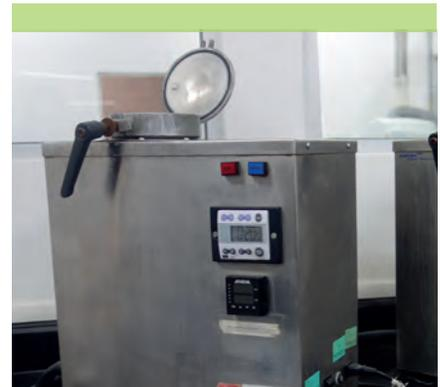
**El digestor permite el análisis completo de la fibra en el alimento. La muestra se deposita en un contenedor especial poroso, donde se desengrasa, y posteriormente pasa a un proceso de digestión, para dejar solamente la fibra vegetal.**
