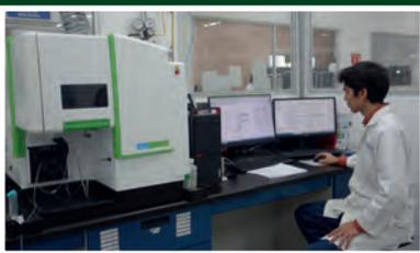
La técnica de espectroscopia por ICP acoplado a plasma, junto con el equipo de microondas favorece la digestión de cualquier tipo de muestra, permitiendo realizar la determinación de minerales a partir de muestras de alimento, agua, leche, suero. Incluso han llegado a trabajar con muestras de tejidos orgánicos, en casos de intoxicación con minerales.
