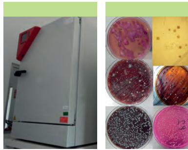
**Incubadoras para cultivo de micoplasma en ambiente anaerobio generado con bióxido de carbono.**
